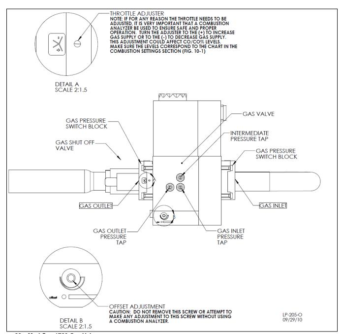
Figure 22 - Mod Con 1700 Gas Valve
