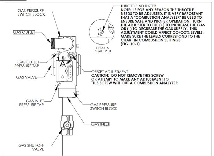
Figure 21 - Mod Con 1000 Gas Valve
